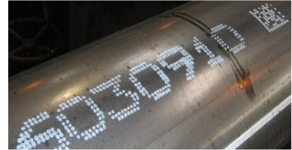
Produktionszahlen und 2D Code auf Stahlrohren
