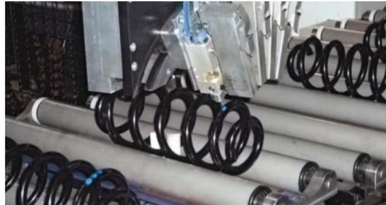
Kennzeichnung von Stahlfedern
