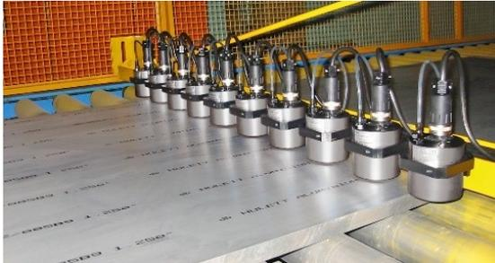
Alphanumerische Kennz. von Aluminiumplatten
