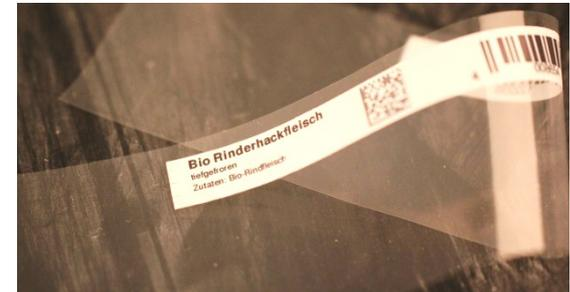
Direktdruck in Farbspiegel auf Folien (Nass-in-Nass)
