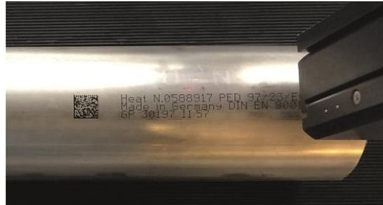
Variable Daten auf Stahlrohren
